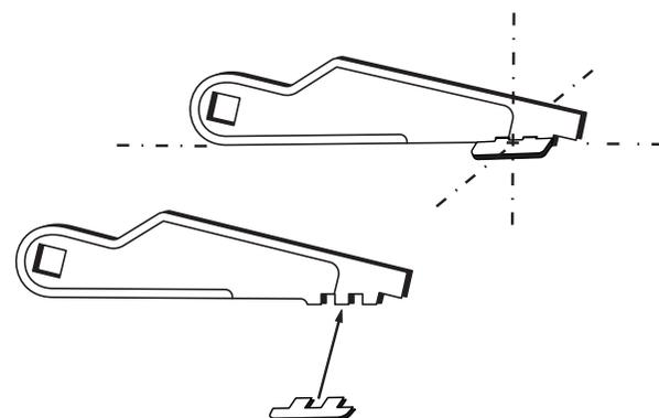
! При склеивании детали следите, чтобы клей не попал на шкант. После высыхания клея, шкант должен легко прокручиваться.
