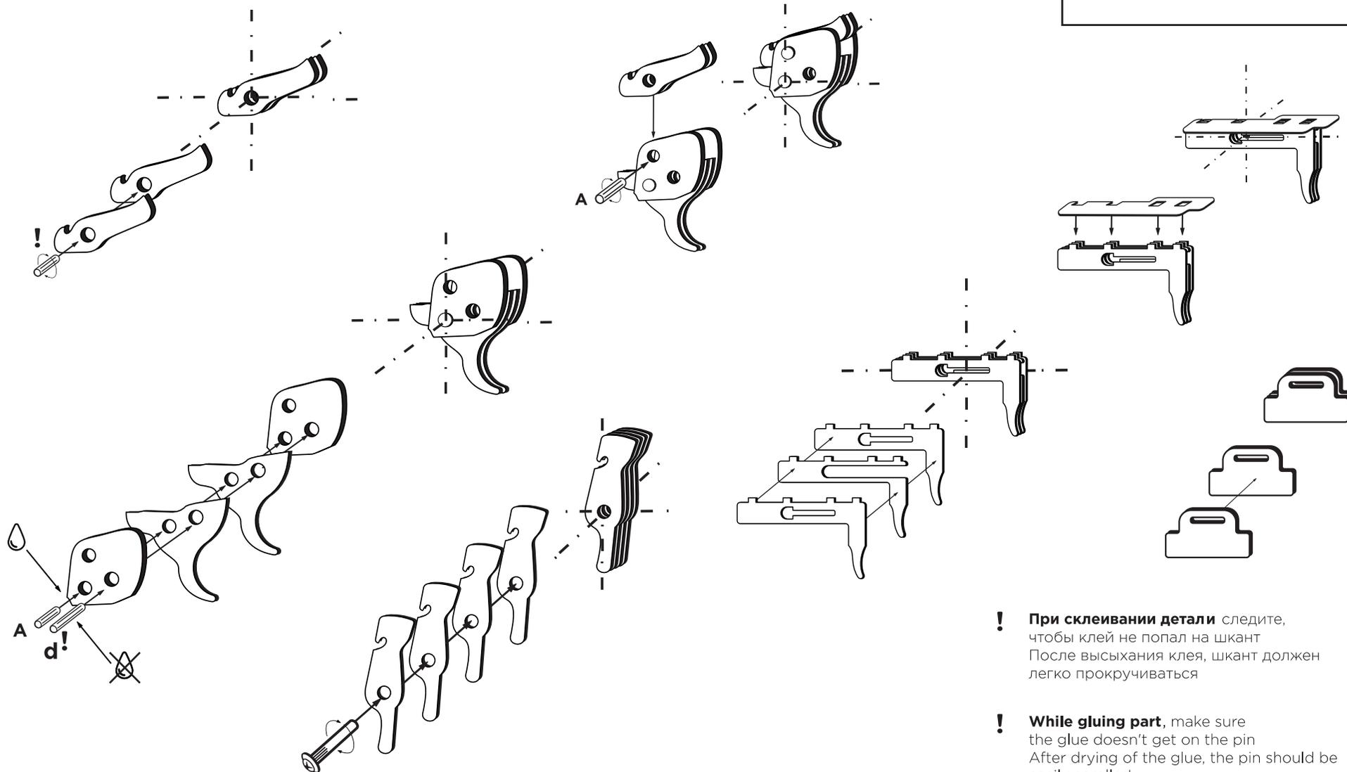
! **При склеивании детали** следите, чтобы клей не попал на шкант. После высыхания клея, шкант должен легко прокручиваться.
